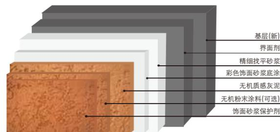
雷帝无机质感灰泥系统构造四
