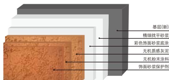
雷帝无机质感灰泥系统构造三
