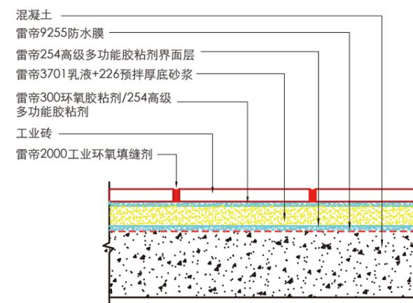
图2.工业砖安装系统构造图
