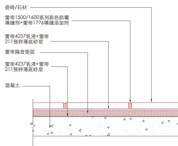
图9. 楼板隔音系统构造图
