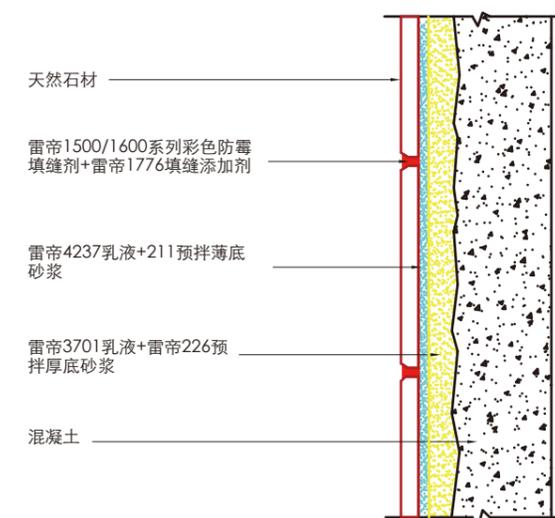
图7.天然石材室内外墙面湿贴系统构造图
