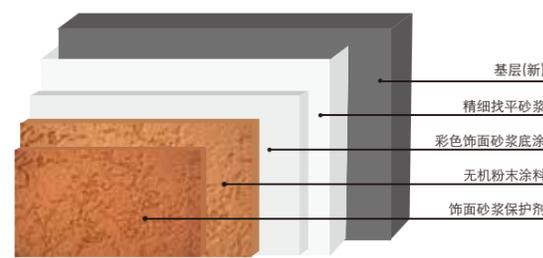
雷帝无机质感灰泥系统构造二
