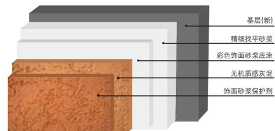
雷帝无机质感灰泥系统构造一
