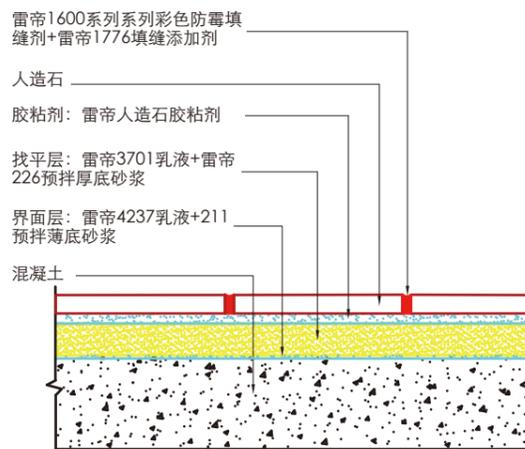
图5.人造石安装系统构造图
