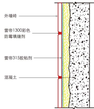
图1.外墙饰面砖安装系统
