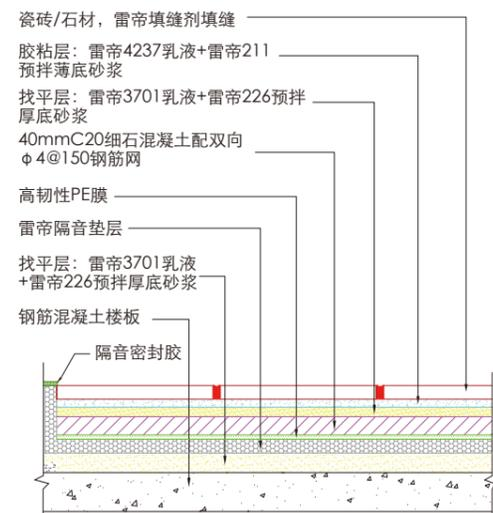
图8. 楼板隔音系统构造图
