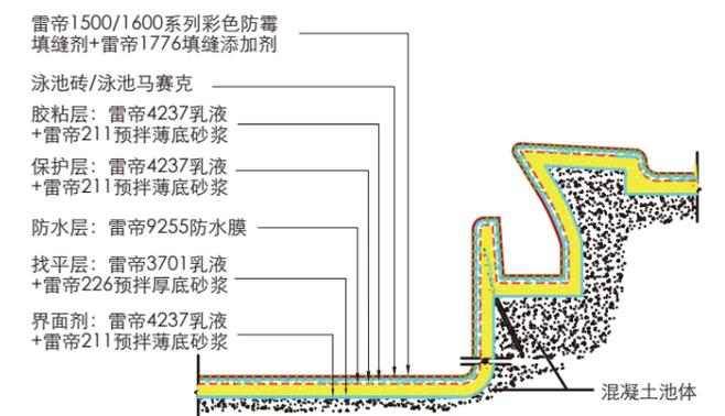
图4.泳池安装系统构造图
