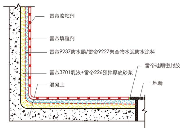
图6.厨卫安装系统构造图
