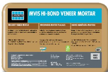
Mortier-collé renforcé de polymères de qualité exceptionnelle, idéal pour la pose de placages encollés grand format de maçonnerie, de pierres, de carreaux de céramique, de pavés ou de briques minces, tant à l'intérieur qu'à l'extérieur. Formulé de manière à offrir une maniabilité et une adhésion sans pareilles, le mortier-collé pour parement à lien fort MVIS se mélange facilement à l'eau.
