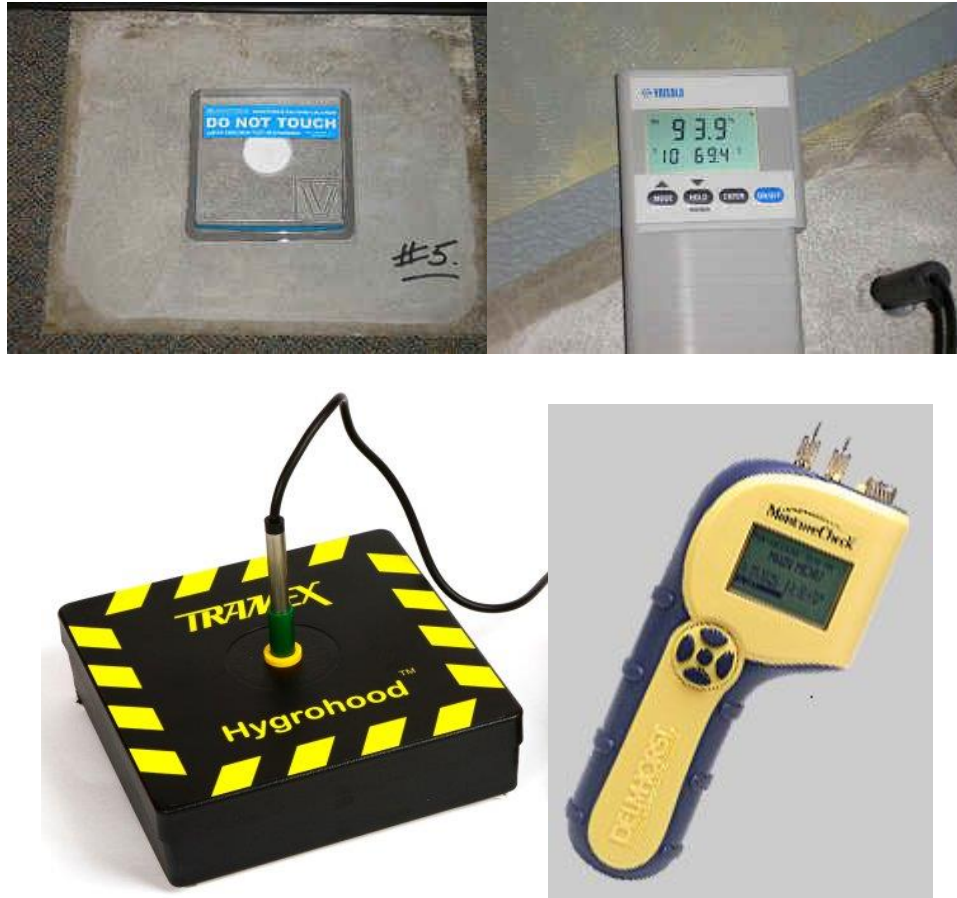
Figura 1.1 – (Desde arriba a la izquierda) ASTM F1869 Kit de prueba de cloruro de calcio, ASTM F2170 método de prueba de sonda de HR, ASTM F2420 Humedad relativa con cubierta aislada, y ASTM F2170 medidor de humedad (fotos cortesía de George Donnelly Testing & Inspections en www.moisturetesting.com , www.tramexltd.com y Delmhorst Instrument Co. en www.delmhorst.com .)
