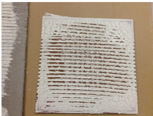
Figura 3: Baldosa de 18" x 18" (450mm x 450mm) instalada con una llana dentada cuadrada de ¼" x ¼" (6 mm x 6 mm); se logró una cobertura insuficiente.
